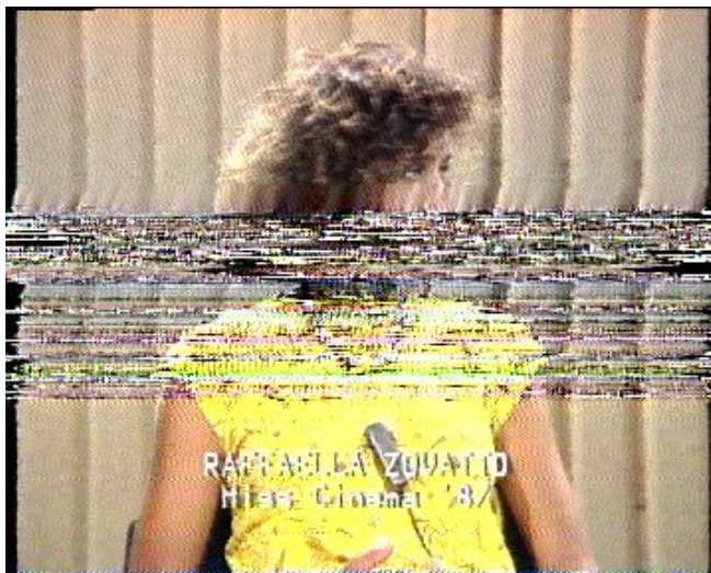
Fig.2.3: Esempio di quadro affetto da dropout.
