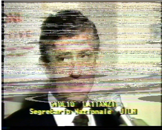
Fig.2.12: 1° esempio di jitter di riga.
