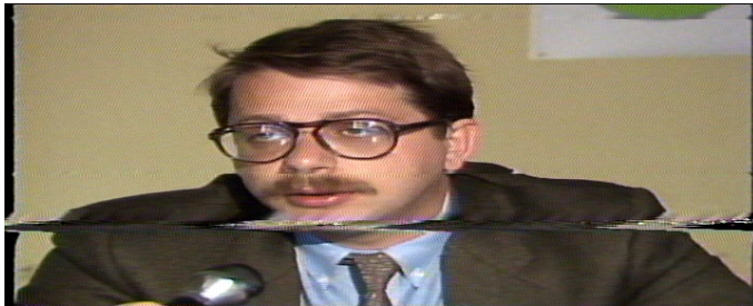
Fig.2.15: 2° esempio di jitter di riga.
